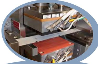
Filigraner Schnitt mit rotativer Schneidwalze.
