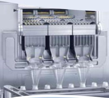
Mechanisch gesteuerte Verschleißeinheit
